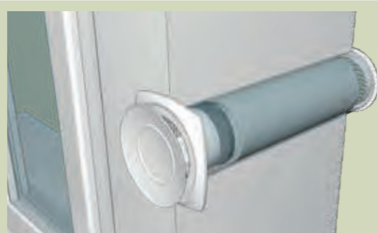
Типовой пример монтажа приточного клапана в стене.
