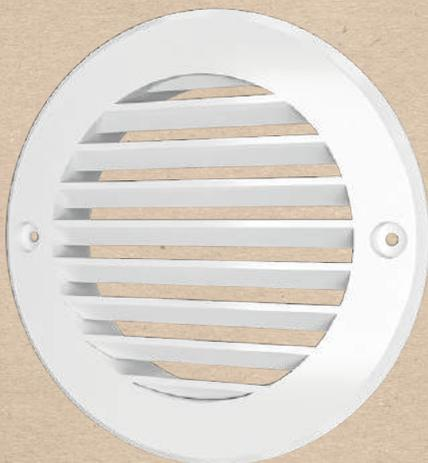
Круглая вентиляционная решетка с фланцем серии **ARK** используется для декоративного оформления выходов приточных и вытяжных вентиляционных систем. Изделие оборудовано монтажным фланцем для соединения с круглыми воздуховодами. Наклонные жалюзи скрывают шахту вентиляции и придают ей эстетичный вид.
