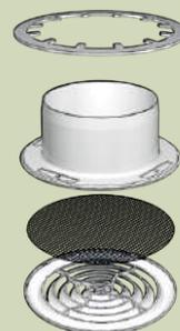
Оригинальная конструкция диффузора поможет надежно прикрепить гибкие воздуховоды AF с помощью стопорного кольца (идет в комплекте). Также стопорное кольцо позволяет закрепить изделие на потолках типа Armstrong.
