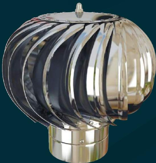
Дефлектор — элемент естественной вентиляции, который усиливает тягу в вентиляционном канале и вытягивает воздух из помещения. Также изделие защищает воздуховод от попадания осадков и мусора, препятствует возникновению обратной тяги. Дефлектор работает под действием ветра, поэтому чем он сильнее, тем быстрее воздухообмен.
