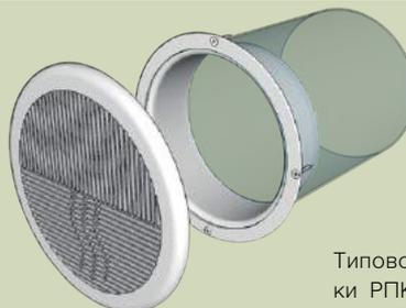
Типовой пример монтажа решетки РПКФ с круглым воздуховодом ВП. Крепление осуществляется с помощью шурупов.
