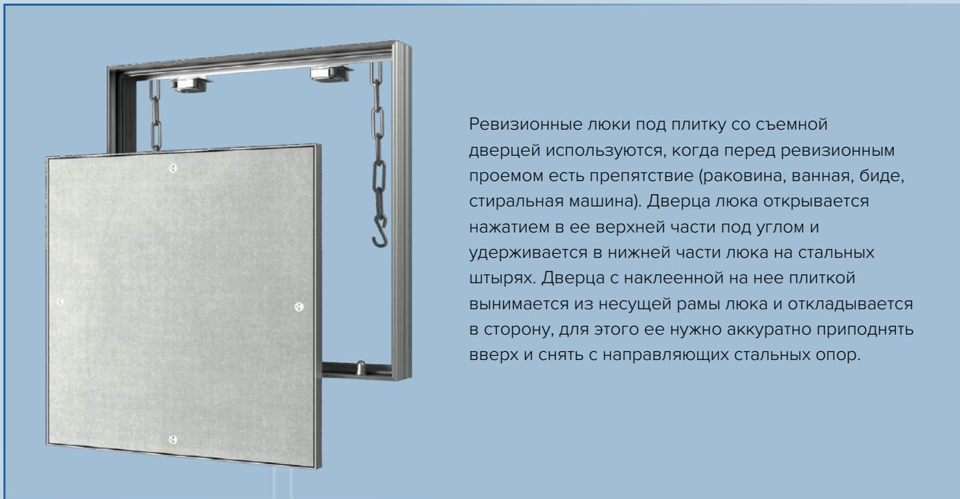
Ревизионные люки под плитку со съемной дверцей используются, когда перед ревизионным проемом есть препятствие (раковина, ванная, биде, стиральная машина). Дверца люка открывается нажатием в ее верхней части под углом и удерживается в нижней части люка на стальных штырях. Дверца с наклеенной на нее плиткой вынимается из несущей рамы люка и откладывается в сторону, для этого ее нужно аккуратно приподнять вверх и снять с направляющих стальных опор.
