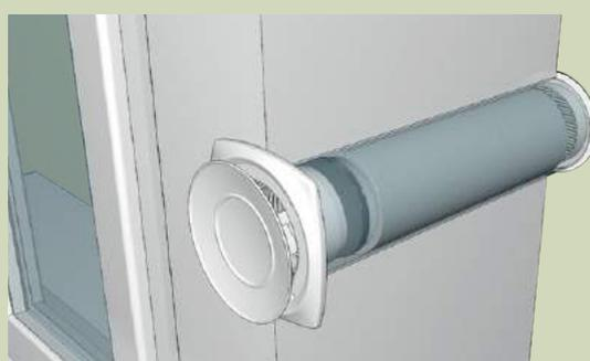
Типовой пример монтажа приточного клапана в стене.
