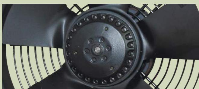
Оборудован электродвигателем с внешним ротором, имеет крыльчатку, изготовленную из металла с черным порошковым покрытием и с установленными серповидными лопастями, которые динамически сбалансированы в двух плоскостях для лучшего шумоподавления.
