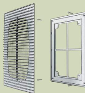
Типовой пример монтажа решетки П с помощью шурупов.
