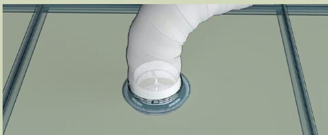
Типовой пример монтажа анемостата АПВП1 с гибким воздуховодом РФ с помощью хомута и фланца Ф.
