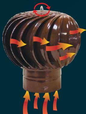
Активная головка дефлектора вращается под воздействием ветра, создавая разрежение в вентиляционном канале, что способствует усилению тяги.
