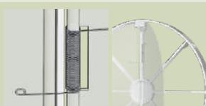
Обратный клапан снабжен пружинным механизмом, который обеспечивает полное перекрытие воздушного потока и не препятствует естественной вентиляции.
