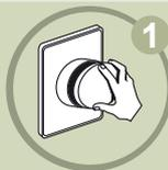
1 Установить клапан на фланец вентилятора в определенном положении.
