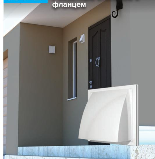
Стенной выход КФВ устанавливается на наружных выходах вентиляционных систем. Состоит из двух частей, что облегчает монтаж и обслуживание. Имеет гравитационный клапан, предотвращающий обратную тягу. КФВ изготавливается из ASA-пластика, сохраняющего внешний вид под воздействием солнечных лучей и атмосферных осадков.
