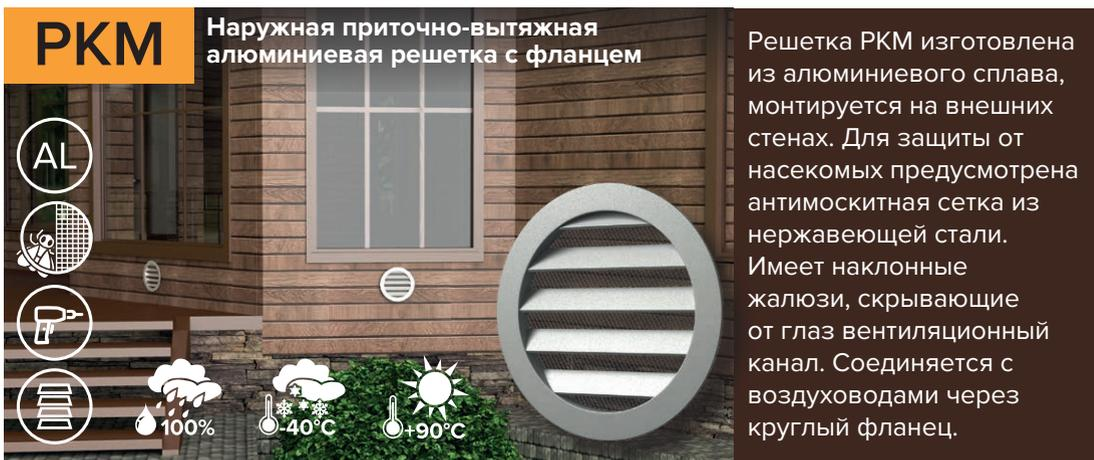
Решетка PKM изготовлена из алюминиевого сплава, монтируется на внешних стенах. Для защиты от насекомых предусмотрена антимоскитная сетка из нержавеющей стали. Имеет наклонные жалюзи, скрывающие от глаз вентиляционный канал. Соединяется с воздуховодами через круглый фланец.
