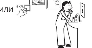
Если освещение включено снова более чем на 1,5 мин., то после выключения освещения вентилятор начнет свою работу заново по таймеру.
