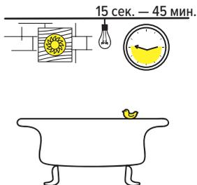
После выключения освещения вентилятор отработает заданное Вами на таймере время (от 15 сек. до 45 мин.) и выключится.
