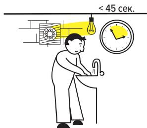
Вентилятор начнет работать через 45 сек. после включения света. Если Вы включили свет меньше чем на 45 сек., вентилятор не заработает.
