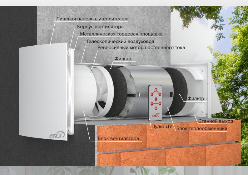
Утеплитель на панели предотвращает появление конденсата при работе рекуператора в холодное время года
