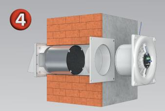
Откройте центральную крышку. Заведите сетевой провод в отверстие сверху корпуса рекуператора. Далее произведите подключение, согласно схеме подключения к сети (рис. 1). Далее закройте крышку с помощью винтов.
