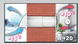
В автоматическом режиме при включении рекуператор вытягивает воздух из помещения. установленного истечении времени переключения (60, 70, 80, либо 90 сек.), происходит автоматическое переключение на приток. При уличной температуре - 15 °C на приток будет поступать воздух + 10 °C. Приток, как и вытяжка, продолжается установленное время. Далее происходит переключение на вытяжку.
