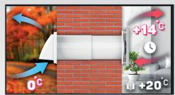
В автоматическом режиме при включении рекуператор вытягивает воздух из помещения. По истечении установленного времени переключения (60, 70, 80, либо 90 сек.), происходит автоматическое переключение на приток. При уличной температуре 0 °С на приток будет поступать воздух + 14 °С. Приток, как и вытяжка, продолжается установленное время. Далее происходит переключение на вытяжку.
