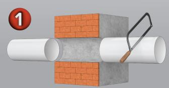
Сделайте отверстие в стене. Для бурения используйте коронку с диаметром корпуса 132 мм. В результате получится отверстие 133 мм. Установите бурильную установку, обеспечив угол оси сверления 2–3 градуса в сторону наружной части стены. Это необходимо для оттока конденсата на улицу.
