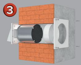
Со стороны помещения в воздуховод установите блок теплообменника. Минимальное расстояние между фланцем рекуператора и теплообменником должно быть не менее 30 мм. Установите монтажную пластину, используя крепеж и монтажный шаблон из комплекта поставки. Со стороны помещения приложите картонный шаблон (см. вкладыш внутри коробки). Большое отверстие в шаблоне должно быть соосным с воздуховодом. Также рекомендуется воспользоваться строительным уровнем для горизонтального выравнивания.
